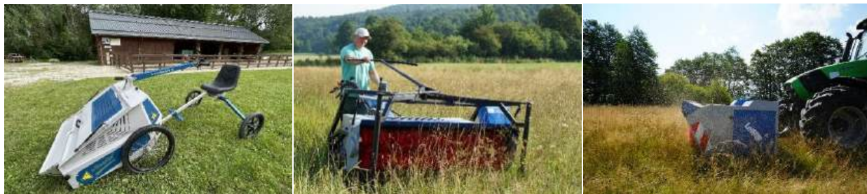
Slika 2. Različni tipi krtačnih strojev (od leve proti desni): električni krtačni stroj, krtačni stroj kot priključek za motokultivator in kot priključek za traktor (foto: Monika Podgorelec, Mateja Grašič, Rudi Kraševce).
